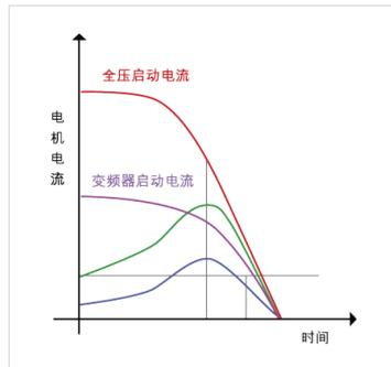
**3. 控制电流延长电机寿命**
